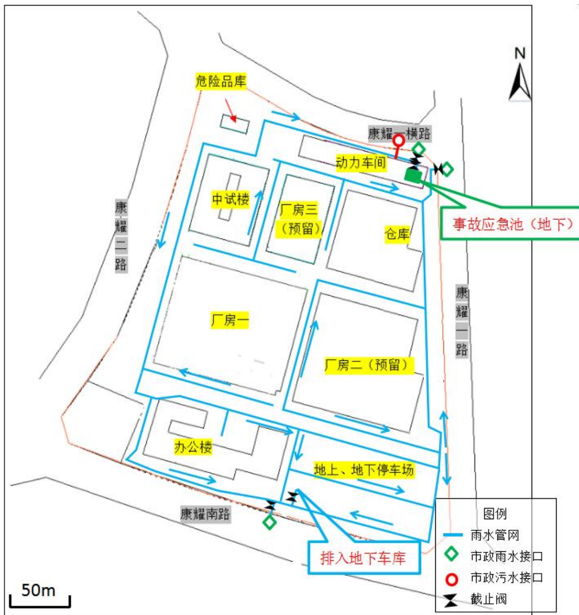
图6.7-2 项目雨水管网平面布置图
